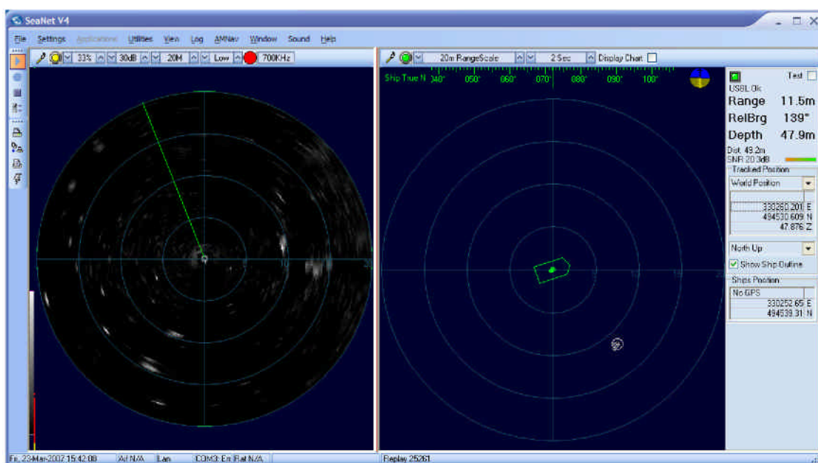
Affichage du sonar à balayage et MicronNav dans SeaNet (position polaire, nord vers le haut).
